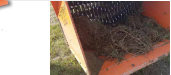
Absieben von Mutterboden am Lagerplatz. Screening topsoil at the storage yard.
