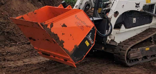
Anbau am Kompaktlader - Absieben von gelagertem Erdaushub von Baustellen auf dem Lagerplatz. Attachment to a skid steer loader - screening stored excavated soil from construction sites at the storage yard.
