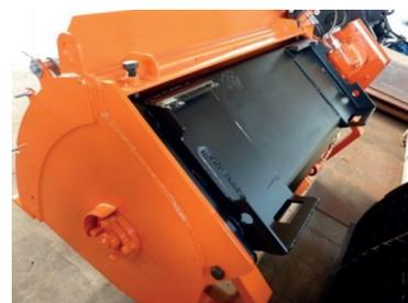
Einfachste Montage der Wechseladapter: werden oben geklemmt und unten verschraubt.
