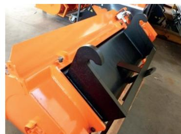
Optional Ausführung mit Wechseladapter für Anbau an Radlader mit unterschiedlichen Anschlagssystemen.
