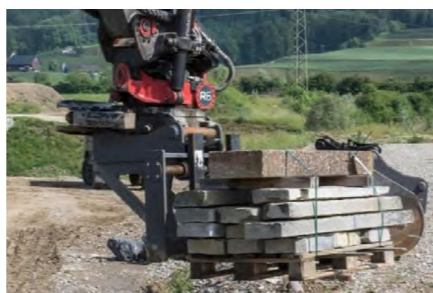
Anbauplatten / Aufhängungen für alle gängigen Schnellwechselsysteme verfügbar.
