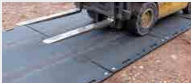
**REMARQUE:** Budget Mats doivent être utilisés que sur un terrain ferme et plat. Il est recommandé de toujours connecter les plaques de roulage. Une limite de vitesse de 5 km/h est à conseiller pour une utilisation optimale.
