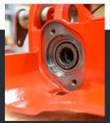
Le nouveau moteur hydraulique offre de meilleures performances, augmente la durée de vie et réduit le risque de fuite. Un joint haute pression rigoureusement testé empêche les fuites entre la vis sans fin et le moteur hydraulique.
