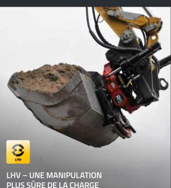
Les vérins d'inclinaison avec vanne de maintien de charge Rototilt permettent de maintenir la charge en toute sécurité, même en cas de perte de pression dans le système hydraulique, due, par exemple, à une rupture de tuyau. Cela offre à la fois des conditions de travail sûres autour de la machine et réduit les dommages aux charges.
