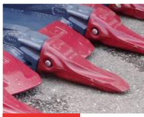
Zahnhalter mit Schutzkappen und Messer mit Schutzsegmenten
