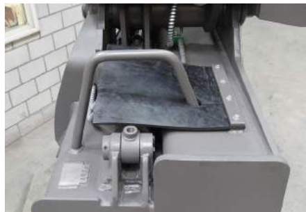
Gummiabdeckung über Zylinder
