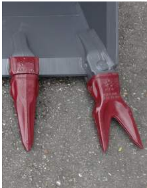
Zähne MTG Halter in Ecke verschleißt
