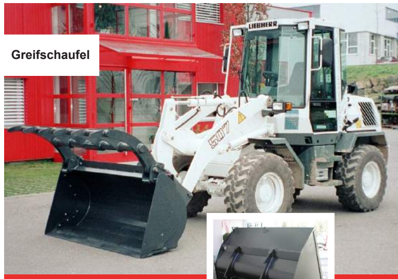
Leichtgutschaufel z.B. für Schneerräumung
