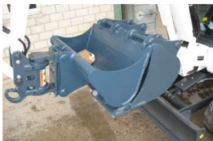
Tieflöffel mit Nase Lade-Mitnahmehilfe
