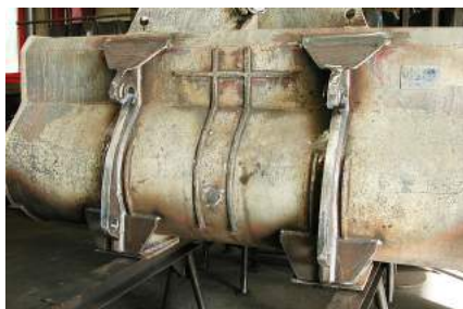
Umbau Ladeschaufel auf Schnellwechsel-System
