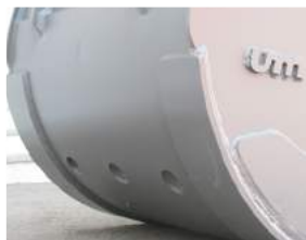
Doppelboden und Kantenschutz
