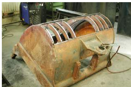
Umbau bestehender Tieflöfel in Gitterlöfel
