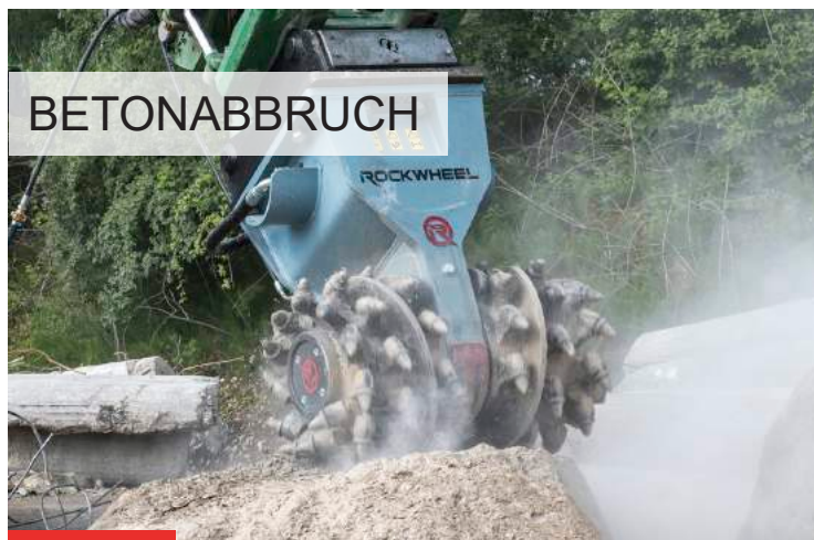
Fräse D20 bei Betonabbruch
