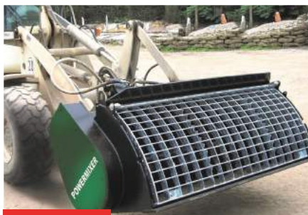
Gewölbtes Schutzgitter mit Zementsackaufreißzähnen.
