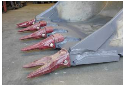
Umbau auf MTG StarMet 40-Felszähne
