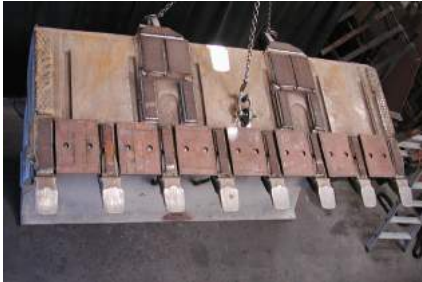
Boden- und Messerschutz Ladeschaufel
