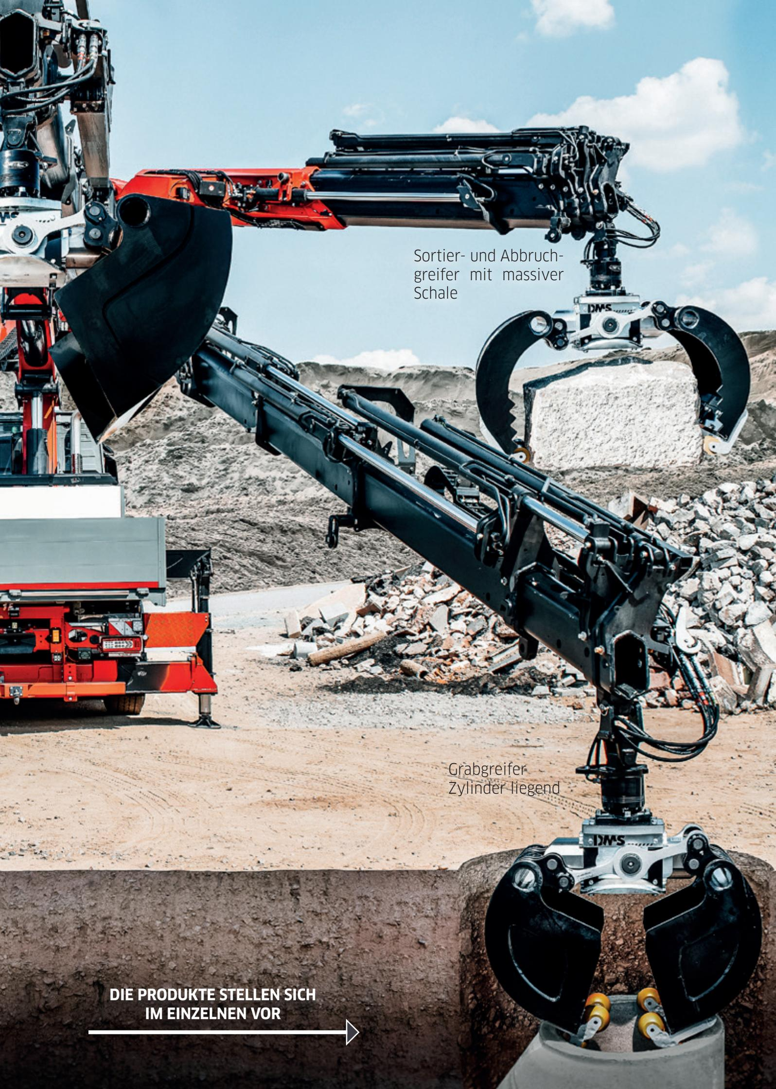
Sortier- und Abbruchgreifer mit massiver Schale
