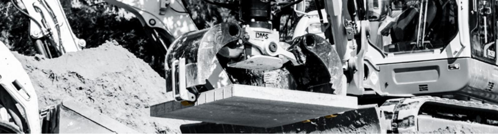
Der **softgrip** macht es möglich! Im Handumdrehen können Sie den DMS Sortiergreifer als Steinsetzzange verwenden!
